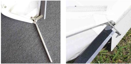
2.10. Sperren Sie die Tip-Strebe indem Sie die Metallführung nach vorne klappen
