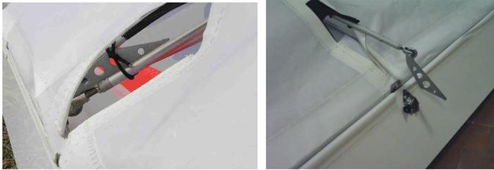
Führen Sie das Rippenspannseil über den Spannhebel;
