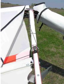
2.6. Schließen Sie jeweils den oberen und unteren Reißverschluß an der Flügelwurzel (Mitte) ca. 1/3 der gesamten Länge.
