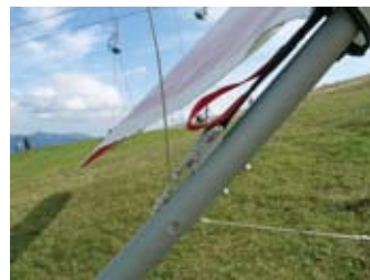
Details des Spirit L: 1. Carbon-Alu-Hybrid-Segellatten sorgen für Gewichtseinsparung, überdies sind sie äußerst robust und präzise. 2. Für liebevolle Detailarbeit sind die Ikarus-Drachen bekannt. 3. Der Knickkiel des Spirit L. 4. Schön gearbeitete Trapezecken passen stimmig ins Erscheinungsbild.
