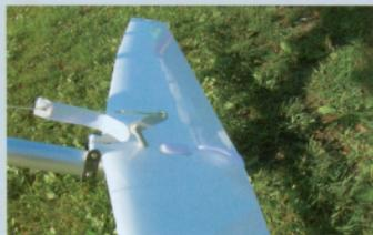
Der Verschluss lässt sich während des Fluges öffnen. Das Leitwerk kann sich dann parallel zur Strömung ausrichten.
