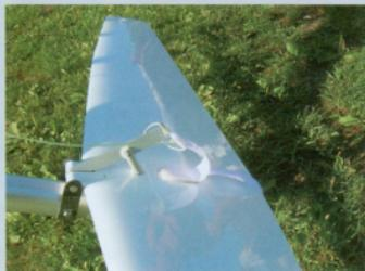
Ein Klettverschluss fixiert die Leitwerkshinterkante am Kielrohr.
