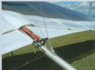
Klappen in Neutralstellung, sobald sich das Segel spannt werden sie automatisch einige Grad nach unten angestellt.
