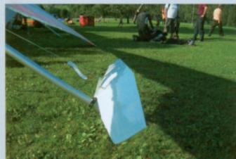
In Landekonfiguration ist die Stabilisierungsfläche zirka 80° angestellt.
