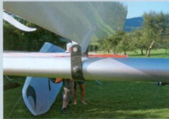
Konsequenter Leichtbau: Auch der U-Beslag, an dem das Leitwerk fixiert wird, besteht aus Carbon.
