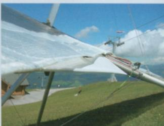
Klappen in Landekonfiguration – der Maximalausschlag ist mit  $25^\circ$  deutlich geringer als bei Starrflüglern.
